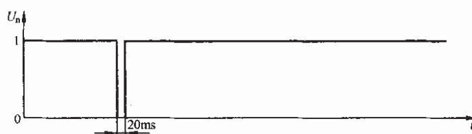
图 A.2 电压中断为 \Delta U = 100\% , 20ms
